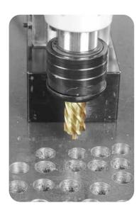
TiN Bohrer Ø 20 mm mehr als 29 Bohrlöcher
